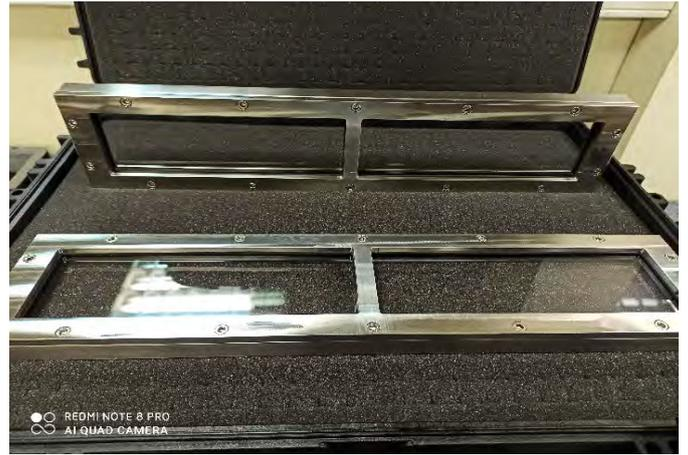
Ventanas para cámara de medición.
