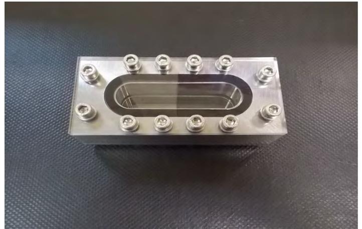
Equipo óptico para una resistencia a la presión de 6 Bar. El tanque de análisis está equipado con ópticas Zafiro y Lexan.
